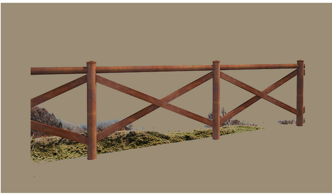
PARAPETTO IN CORTEN tipo CADORE CORTEN SAFE H3C-3; altezza montanti 1150 mm, passo 2600 mm o equivalente
